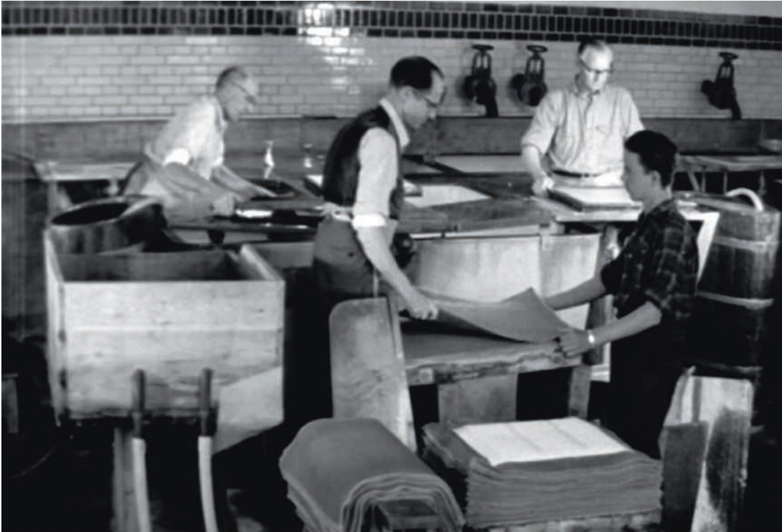
Øsebøttens mandskab. Fra venstre 1. øser, gauskeren, 2. øser og over for gauskeren filtsnapperen. Bagerst ses tre store haner i væggen, hvorfra stoffet kommer fra hollænderiet ned i forsyningskarret. Foran gauskeren og filtsnapperen står den igangværende "post". På bukken til venstre herfor ligger de resterende filte til posten. Bag gauskeren er det store skyllekar til formen. 2. øseren har sat sin form på sugebordet.
